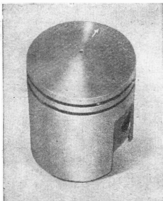
Bild 64. Kolben (Pfeil muß beim Einbau nach vorn zeigen!)
